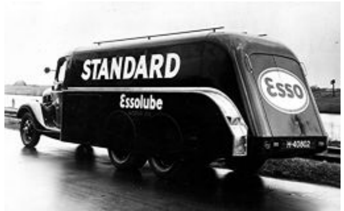
Foto 19. Een tankwagen voor ESSO op een Ford V8-truckchassis uit ongeveer 1935 (bron: coll. Hans Waldeck, De Wijk).
