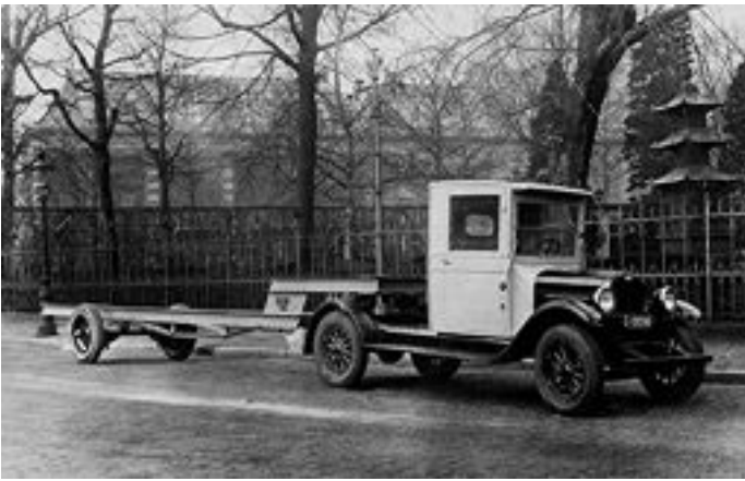
Foto 16. Een voorloper van de Ankel-trailer met een Chevrolet-trekker uit ongeveer 1927 (bron: coll. Hans Waldeck, De Wijk).
