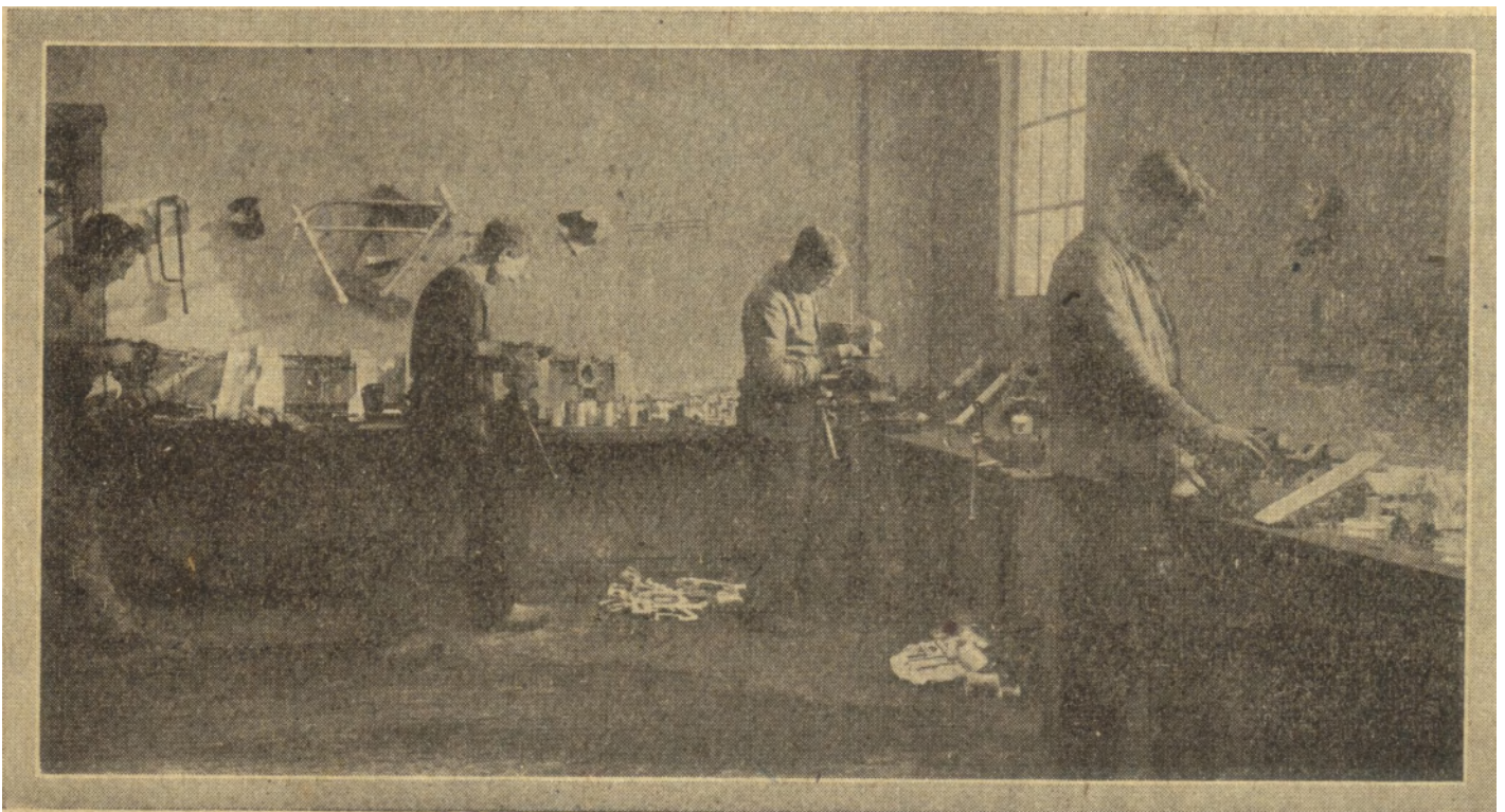
1920.5 Aluminiumdelen zoals magneetaandrijvingsdeksels, carters en voetplanken worden met de vijl nabewerkt. Let op het frame aan de muur. Misschien een mal om de blokjes in te passen of een suggestie voor de kijker dat dit onderdeel ook binnenshuis gefabriceerd wordt?
