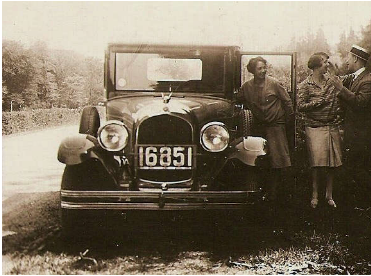
N°16851 – Type 3A (lichtblauw) – 1921 – opengewerkt émail Een eenvoudig frame met verwijderbare cijfers om de ventilatie van de radiator te vergemakkelijken
