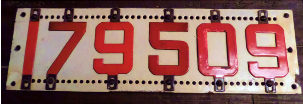
Plaat voor aanhangwagen : plaat in metaal et verwijderbare cijfers in émail (14,5 x 48 cm)
