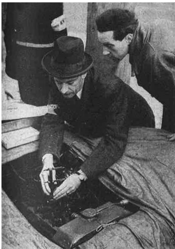
Controle op de cilinderinhoud is bij recordpogingen een officiële eis. Op de foto wordt de opengelegde motor van de Gatso 1500 nagemeten.
