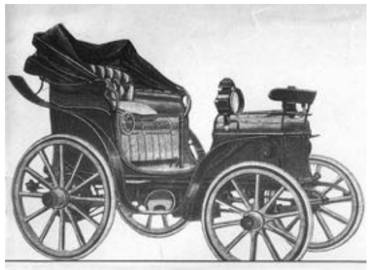
Een BGS elektrische auto. De elektrische krachtbron had een vermogen van 7 pk, gevoed door batterijen met een vermogen van circa 84 volt, waarmee het voertuig een topsnelheid van 27 km/h bereikte.
